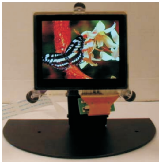
圖 2. Sanyo 與 Kodak 2.4 吋全彩主動矩陣 (LTPS TFT) 之 OLED 面板。
