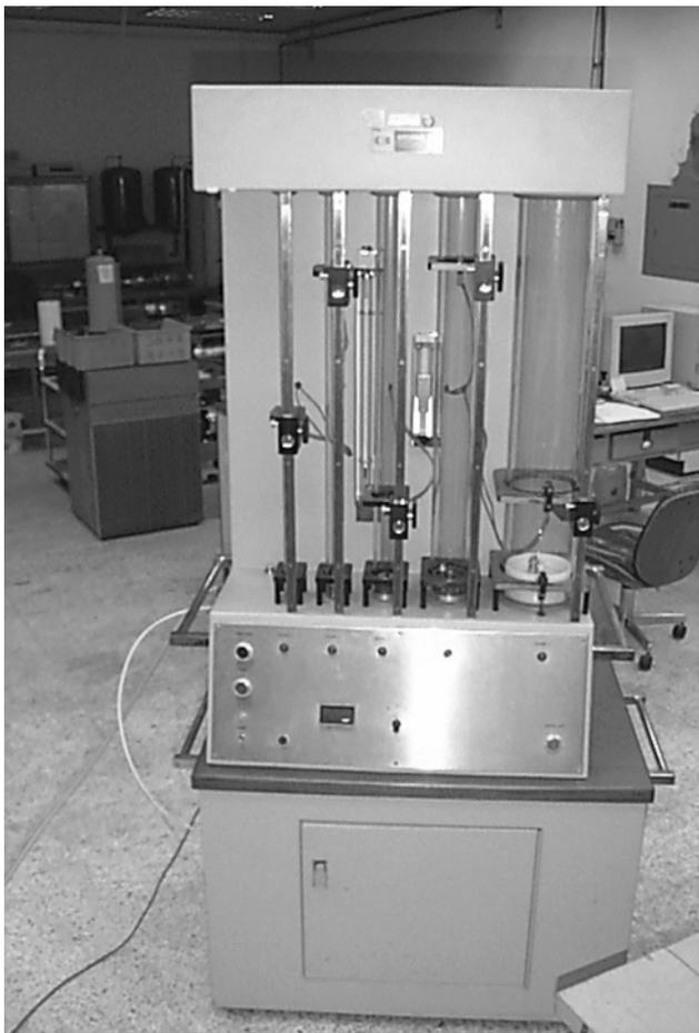
圖 1. 多管式氣體流量計校正系統全圖。
