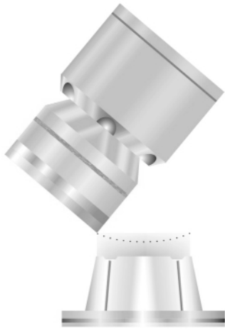
圖 4. 杯狀砂輪由鏡片的邊緣向鏡片的中心點輪磨。
