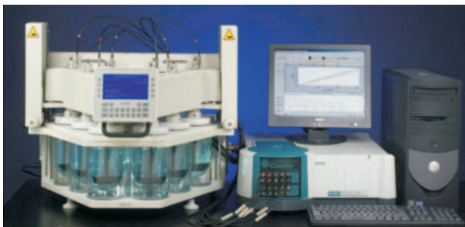
圖 1. 自動化溶離試驗光纖原位測定系統。
