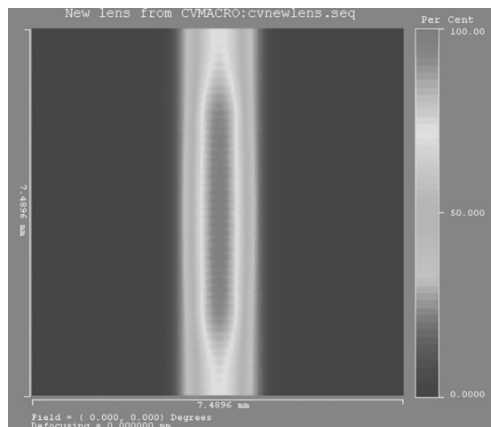
圖 15. 光學軟體模擬雷射加工聚焦「貓眼」光點 (球面鏡 R_s = 75 mm，柱面鏡 R_c = 35 mm)。
