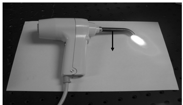
圖 3. 台大醫院及工研院共同研發，用於光動力治療用的 LED 光源。(轉載自 Lasers in Surgery and Medicine, 34, 18)
