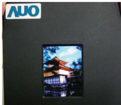
圖 6. AUO 發表之 in-cell multi touch/AMOLED 面板。
