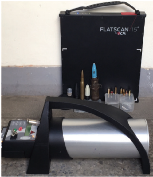
圖 3. 應用於高爆彈殺傷力鑑定之攜帶式 X 光掃描攝影設備。
