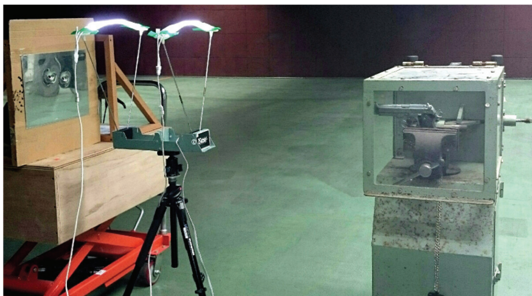
圖 1. 槍彈殺傷力鑑定設備，左至右依序為監測鋁板、彈丸測速器、槍枝及固定座。
