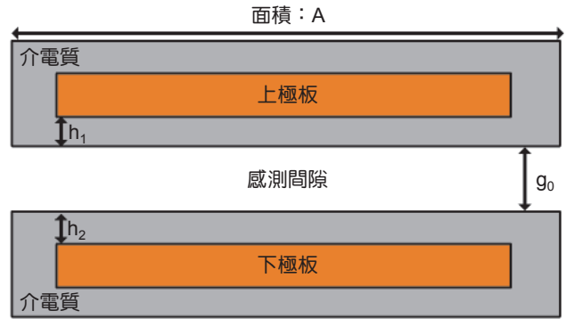
圖 1. 電容感測器結構示意圖。
