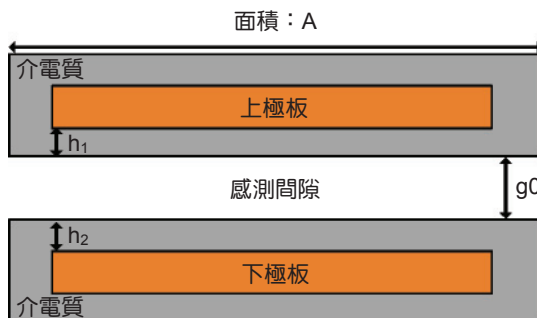
圖 2. 電容式感測器壓力偵測原理。
