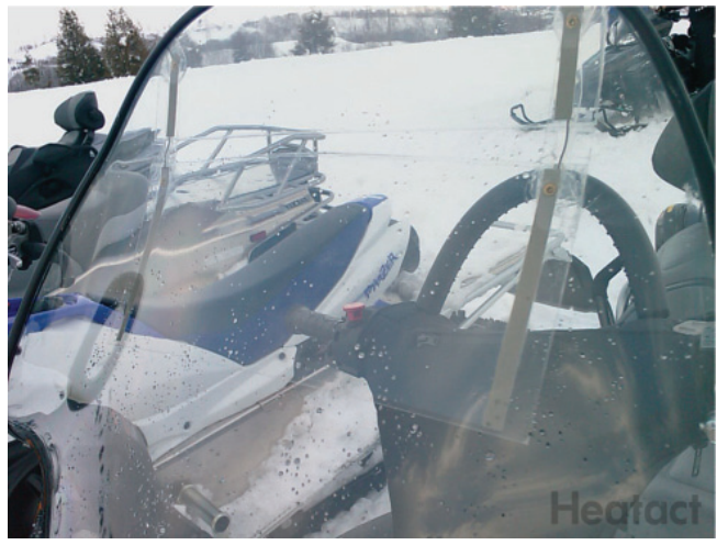
圖 3. 透明薄膜式電熱元件應用於雪地車用玻璃除霧裝置 (7) 。
