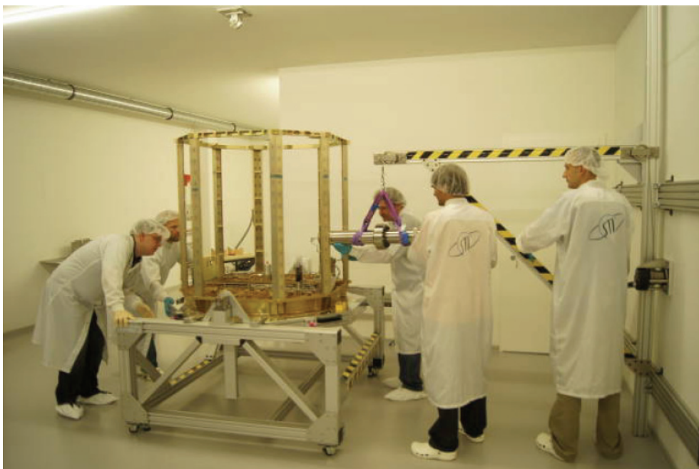
圖 6. 推進次系統組裝燃料槽虛擬質量體。
