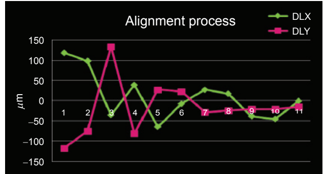
圖 9. 調整過程中次鏡偏心量變化。
