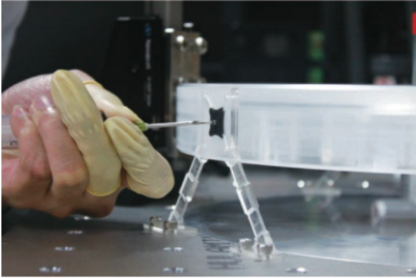
圖 3. 結構膠材進行灌膠黏著接合。
