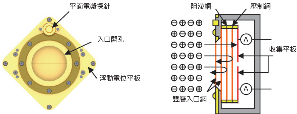
圖 4. 先進電離層探測儀的探測器剖面圖。
