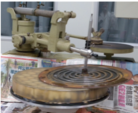
圖 4. 主反射鏡預拋光。
