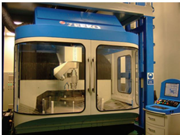
圖 6. 大口徑非球面鏡 CNC 數控拋光機。
