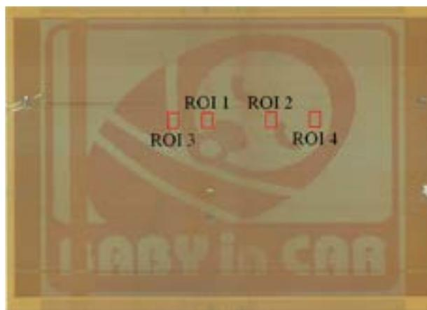
圖 9. ChLCD 的圖像測量區域。
