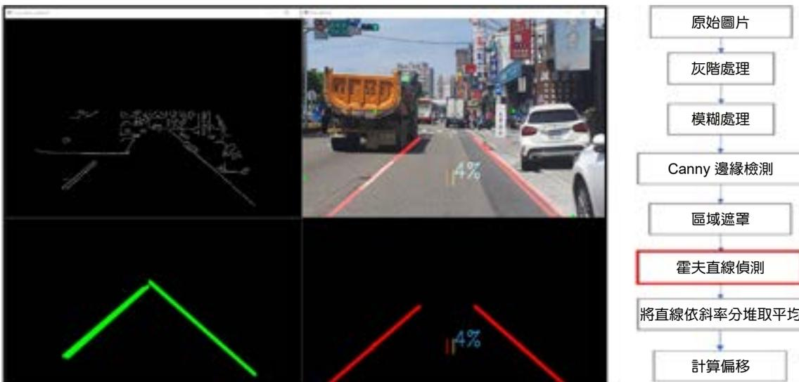
圖 18. 路線偵測和計算車體偏移。
