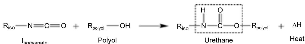
圖 6. 反應產生氨基甲酸酯基團<sup>(25)</sup>。
