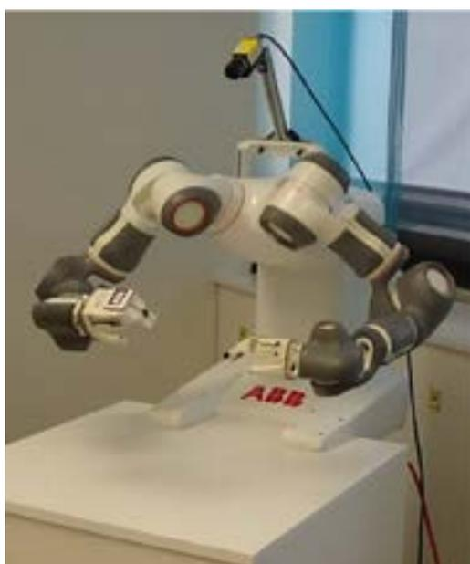
圖 9. ABB 雙臂機器人之手眼校正配置<sup>(2)</sup>。
