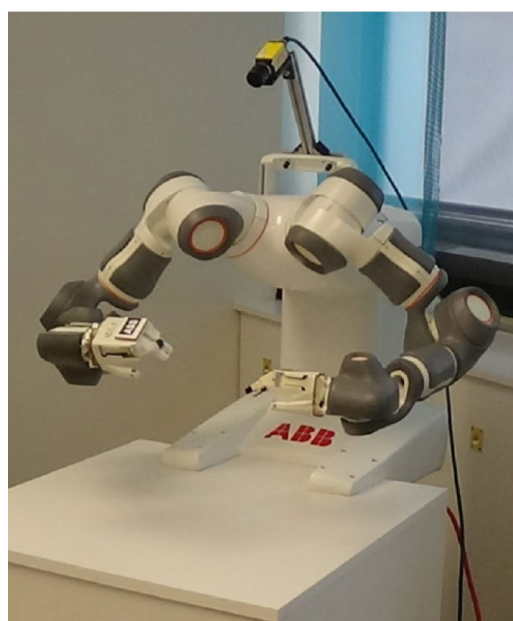
圖 9. ABB 雙臂機器人之手眼校正配置 (2) 。
