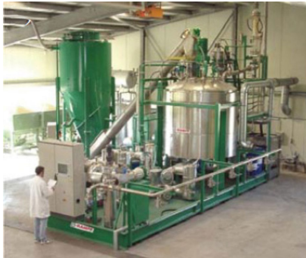
圖 13. RAMPF 的 PU 化學回收系統 (37) 。
