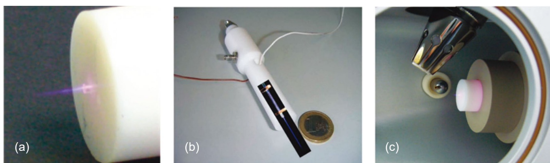
圖 5. 筆形介電質放電氮氣電漿游離源 (a) 筆型電漿以氮氣放電之影像 (b) 整體筆型電漿實體影像 (c) 筆型電漿放置於質樸儀入口之架設圖 (10) 。
