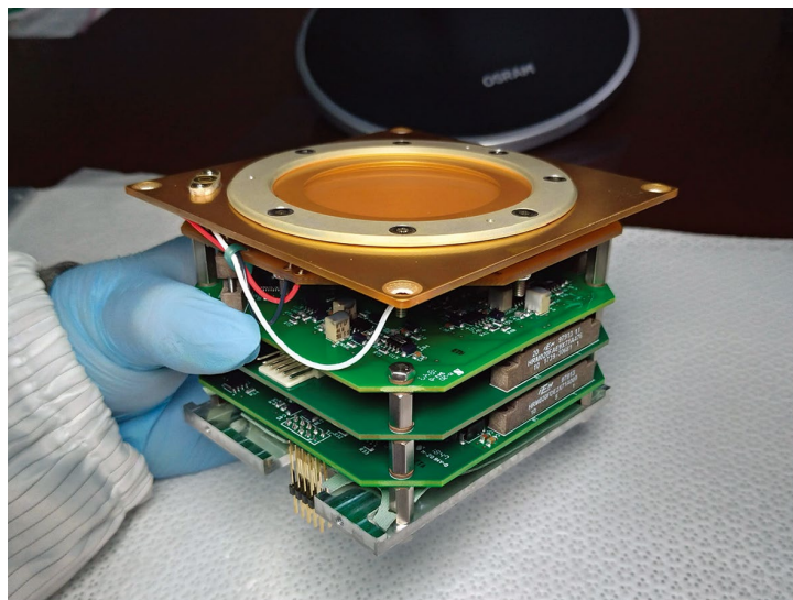
圖 1. 小型電離層探測儀。電路板由上而下分別是開口與篩網模組、類比前端處理單元、數位控制單元、電源管理單元。
