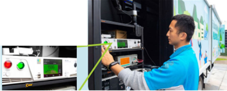
圖 12. 絕緣阻抗測試示意圖。
