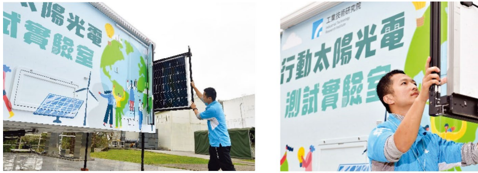
圖 4. (圖左) 模組固定支架；(圖右) 目視檢查示意圖。
