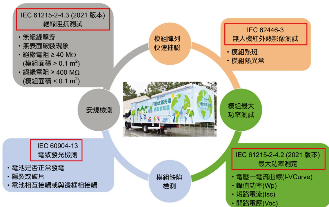
圖 3. 行動太陽光電測試實驗室檢測事項。
