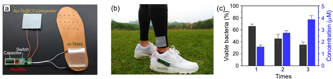
圖 12. 殺菌系統裝置 (a) 內部元件 (b) 裝置應用示範 (c) 不同充電放電次數之下細菌存活率與 H_2O_2 產生濃度。
