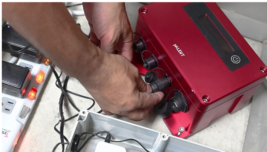
臺北捷運採用三聯科技「pALERT F330 力平衡地震 P 波監測儀」，進行地震預警防護。
