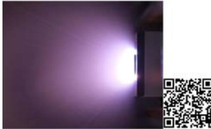
圖 4. 由國立成功大學李約亨教授實驗室所開發之多層絕緣層之真空電弧推進器放電圖。
