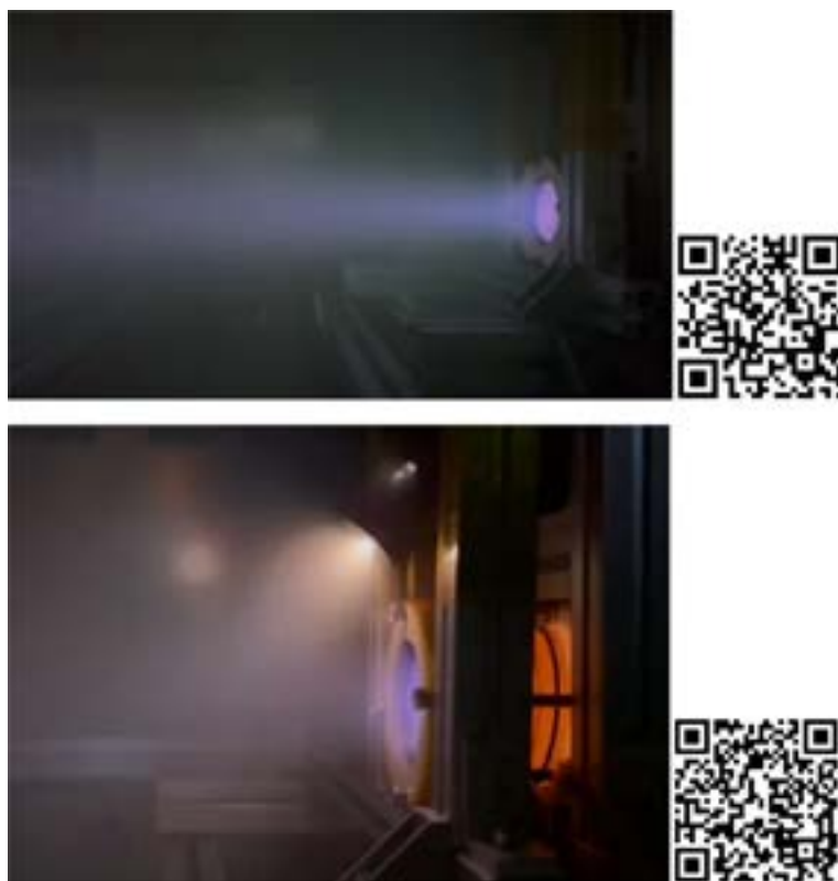
圖 5. 由成功大學航太系李約亨教授實驗室開發之離子推進器 (上圖為 35 瓦 RF 離子推進器，下圖為 RF 離子推進器結合中空陰極中合器)。
