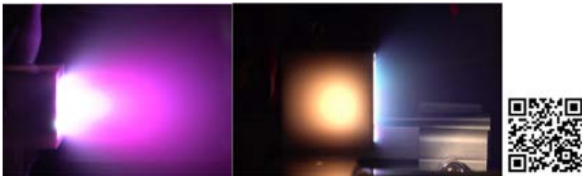
圖 2. 成大李約亨老師團隊所開發的新型脈衝式電漿推進器 VAI-PPT (a.與國家太空中心共同開發)。
